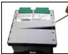
Insertar la tarjeta de expansión en la guía.
